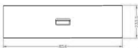
Dimensioni e proiezione n. 2 cassetti dim. cm 81,5 x 39,8 x 23,5 H
